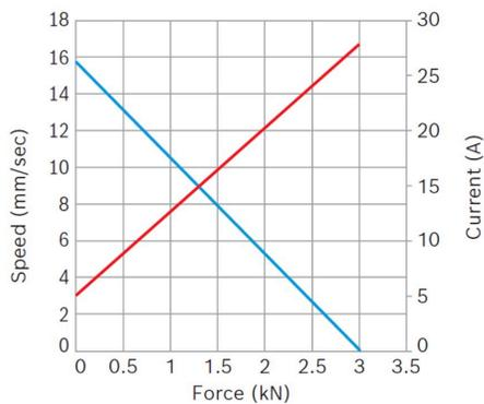
**Puissance nominale (W):** 6,5**Courant nominal (A):** 9**Force nominale (kN):** 0,5**Force maximale (kN):** 3**Vitesse (mm/s):** 13**Course (mm):** 81,6**Capteur à effet Hall:** Oui
