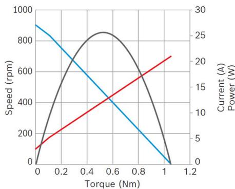
**Puissance nominale (W):** 8,8**Courant nominal (A):** 5**Vitesse nominale (rpm):** 845**Couple nominal (Nm):** 0,1**Couple de desserrage (Nm):** 1,05**Rapport de transmission:** 27:4**Capteur à effet Hall:** Non**Position de la boîte de vitesses:** Gauche
