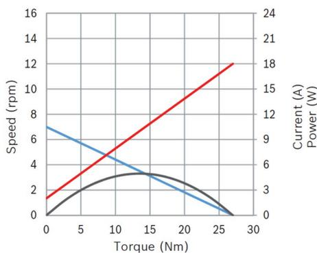
**Puissance nominale (W):** 1,3**Courant nominal (A):** 4,2**Vitesse nominale (rpm):** 6,4**Couple nominal (Nm):** 2**Couple de desserrage (Nm):** 27,5**Rapport de transmission:** 506:1**Capteur à effet Hall:** Oui**Côté boîte de vitesses:** Droite
