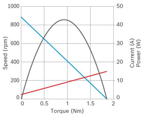
**Puissance nominale (W):** 8,8**Courant nominal (A):** 3,2**Vitesse nominale (rpm):** 841**Couple nominal (Nm):** 0,1**Couple de desserrage (Nm):** 1,85**Rapport de transmission:** 27:4**Capteur à effet Hall:** Oui**Position de la boîte de vitesses:** Droite
