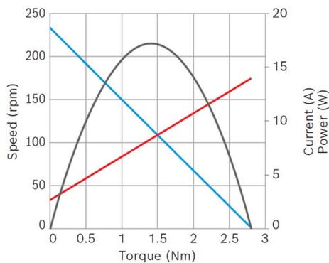
**Puissance nominale (W):** 6,6**Courant nominal (A):** 3,8**Vitesse nominale (rpm):** 210**Couple nominal (Nm):** 0,3**Couple de desserrage (Nm):** 2,8**Rapport de transmission:** 28:2**Capteur à effet Hall:** Oui**Position de la boîte de vitesses:** Gauche
