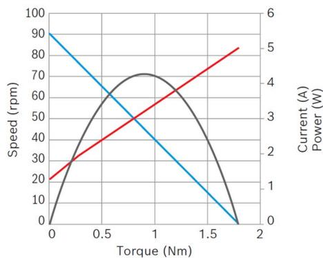
**Puissance nominale (W):** 2,4**Courant nominal (A):** 2**Vitesse nominale (rpm):** 75**Couple nominal (Nm):** 0,3**Couple de desserrage (Nm):** 1,8**Rapport de transmission:** 29:1**Capteur à effet Hall:** Oui**Côté boîte de vitesses:** Gauche
