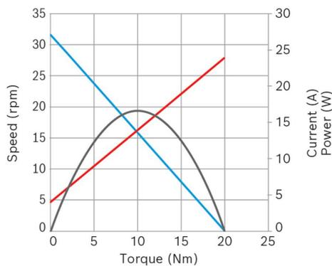
**Puissance nominale (W):** 6,1**Courant nominal (A):** 6**Vitesse nominale (rpm):** 29**Couple nominal (Nm):** 2**Couple de desserrage (Nm):** 20,5**Rapport de transmission:** 185,5:1**Capteur à effet Hall:** Oui**Position de la boîte de vitesses:** Droite
