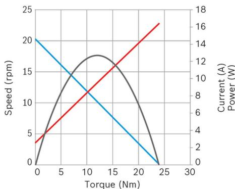
**Puissance nominale (W):** 3,9**Courant nominal (A):** 3,7**Vitesse nominale (rpm):** 18,65**Couple nominal (Nm):** 2**Couple de desserrage (Nm):** 21,5**Rapport de transmission:** 217:1**Capteur à effet Hall:** Non**Position de la boîte de vitesses:** Droite
