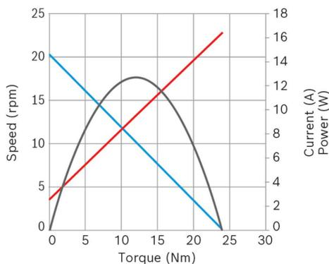
**Puissance nominale (W):** 3,9**Courant nominal (A):** 3,7**Vitesse nominale (rpm):** 18,65**Couple nominal (Nm):** 2**Couple de desserrage (Nm):** 21,5**Rapport de transmission:** 217:1**Capteur à effet Hall:** Oui**Position de la boîte de vitesses:** Gauche
