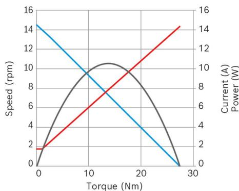
**Puissance nominale (W):** 1,5**Courant nominal (A):** 1,8**Vitesse nominale (rpm):** 14,1**Couple nominal (Nm):** 1**Couple de desserrage (Nm):** 27,5**Rapport de transmission:** 217:1**Capteur à effet Hall:** Oui**Position de la boîte de vitesses:** Droite
