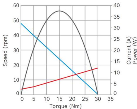
**Puissance nominale (W):** 20,9**Courant nominal (A):** 3,5**Vitesse nominale (rpm):** 40**Couple nominal (Nm):** 5**Couple de desserrage (Nm):** 30**Rapport de transmission:** 108:2**Capteur à effet Hall:** Non**Sens de rotation:** links- und Rotation à droite
