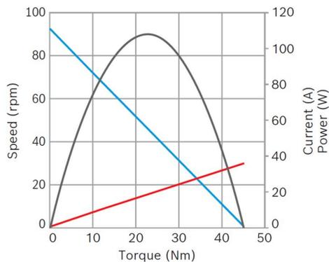
**Puissance nominale (W):** 50,2**Courant nominal (A):** 6**Vitesse nominale (rpm):** 80**Couple nominal (Nm):** 6**Couple de desserrage (Nm):** 45**Rapport de transmission:** 108:2**Capteur à effet Hall:** 2x**Sens de rotation:** Rotation à gauche et à droite
