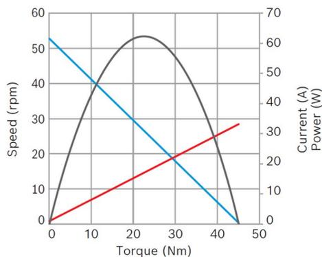
**Puissance nominale (W):** 50,2**Courant nominal (A):** 10**Vitesse nominale (rpm):** 42**Couple nominal (Nm):** 10**Couple de desserrage (Nm):** 45**Rapport de transmission:** 108:2**Capteur à effet Hall:** 2x**Sens de rotation:** Rotation à gauche et à droite
