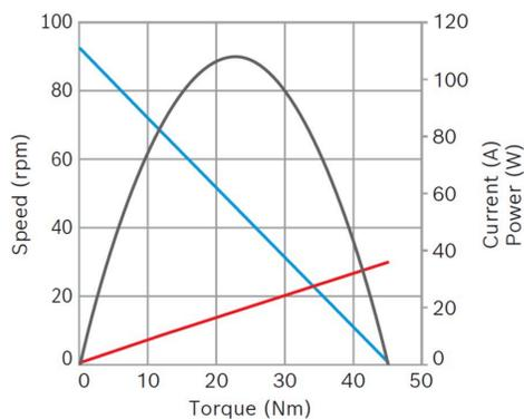
**Puissance nominale (W):** 38,7**Courant nominal (A):** 8,5**Vitesse nominale (rpm):** 37**Couple nominal (Nm):** 10**Couple de desserrage (Nm):** 40**Rapport de transmission:** 78:1**Capteur à effet Hall:** 2x**Sens de rotation:** Rotation à gauche et à droite
