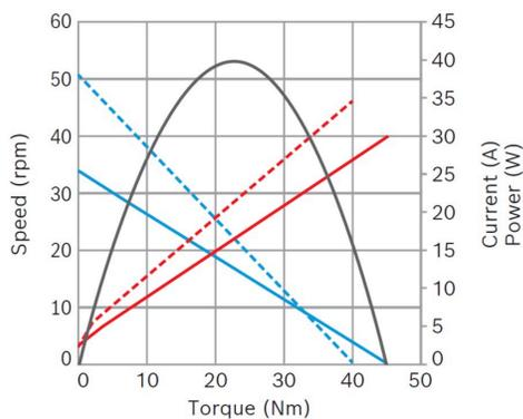
**Puissance nominale (W)\*:** 8,4 / 12,5**Courant nominal (A)\*:** 4,5 / 6**Vitesse nominale (rpm)\*:** 32 / 48**Couple nominal (Nm):** 2,5**Couple de desserrage (Nm)\*:** 45 / 40**Rapport de transmission:** 80:2**Sens de rotation:** Rotation à gauche**Capteur à effet Hall:** Non**Position de la boîte de vitesses:** Gauche
