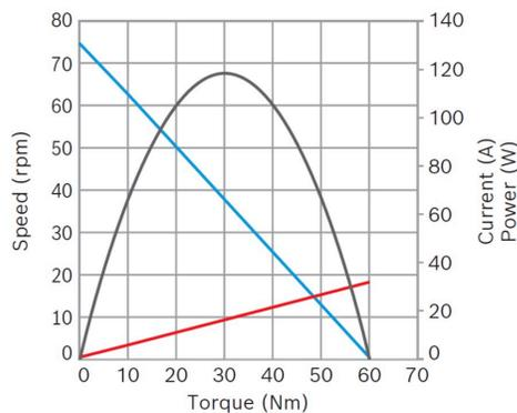
**Puissance nominale (W):** 65,9**Courant nominal (A):** 6**Vitesse nominale (rpm):** 63**Couple nominal (Nm):** 10**Couple de desserrage (Nm):** 60**Rapport de transmission:** 80:2**Sens de rotation:** Rotation à gauche et à droite**Capteur à effet Hall:** Non**Position de la boîte de vitesses:** Gauche
