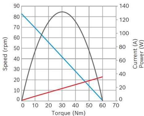
**Puissance nominale (W):** 73,3**Courant nominal (A):** 7**Vitesse nominale (rpm):** 70**Couple nominal (Nm):** 10**Couple de desserrage (Nm):** 60**Rapport de transmission:** 80:2**Sens de rotation:** Rotation à gauche et à droite**Capteur à effet Hall:** Non**Position de la boîte de vitesses:** Gauche
