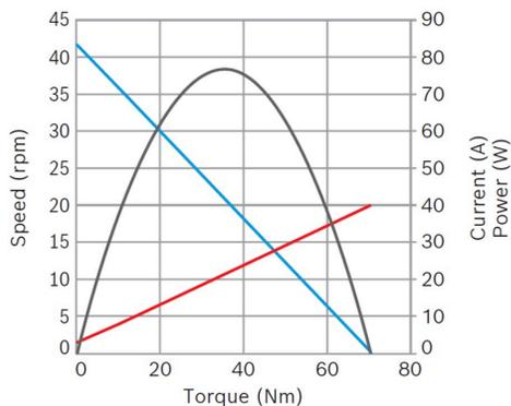
**Puissance nominale (W):** 20,4**Courant nominal (A):** 5**Vitesse nominale (rpm):** 39**Couple nominal (Nm):** 5**Couple de desserrage (Nm):** 70**Rapport de transmission:** 65:1**Sens de rotation:** Rotation à gauche et à droite**Capteur à effet Hall:** Non**Position de la boîte de vitesses:** Gauche
