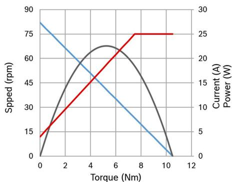
**Puissance nominale (W):** 8,6**Courant nominal (A):** 6**Vitesse nominale (rpm):** 82**Couple nominal (Nm):** 1**Couple de desserrage (Nm):** 10**Rapport de transmission:** 73:1**Position de la boîte de vitesses:** Droite
