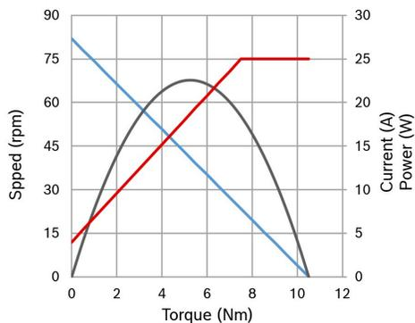
**Puissance nominale (W):** 8,6**Courant nominal (A):** 6**Vitesse nominale (rpm):** 82**Couple nominal (Nm):** 1**Couple de desserrage (Nm):** 10**Rapport de transmission:** 73:1**Position de la boîte de vitesses:** Gauche
