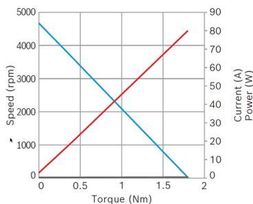
**Puissance nominale (W):** 122,5**Courant nominal (A):** 115**Vitesse nominale (rpm):** 3900**Couple nominal (Nm):** 0,3**Couple de desserrage (Nm):** 1,8**Capteur à effet Hall:** Non
