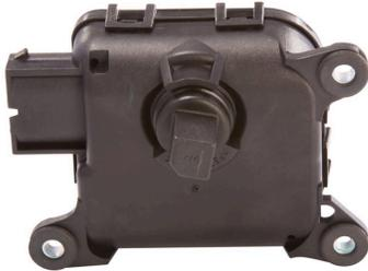
Le servomoteur HVAC compact VMC 0132801141 se distingue par sa capacité à fournir instantanément un couple à bas régime, tout en nécessitant un espace de montage minimal.
