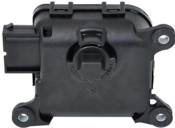
Comparé aux moteurs pas à pas, l'actionneur compact Bosch VMC 0132801169 présente des avantages notables. Le couple de démarrage est immédiatement disponible, ce qui élimine tout délai au démarrage. Contrairement aux moteurs pas à pas, cet actionneur ne nécessite pas de retour à la position de départ à chaque activation, ce qui réduit les bruits indésirables, fait gagner du temps et améliore l'efficacité.
