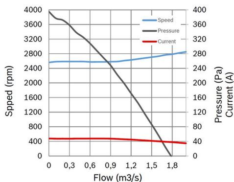
Puissance à 95% PWM, temps de fonctionnement limité
